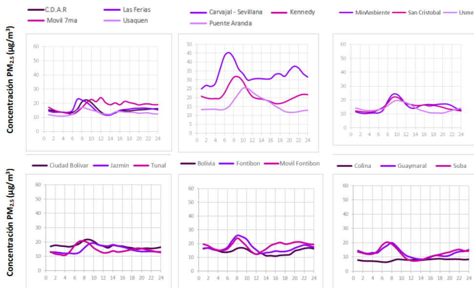
Figura 9. Comportamiento horario de las concentraciones de PM 2.5 – Año 2022. Fuente: Elaboración propia SDA y SDS.
